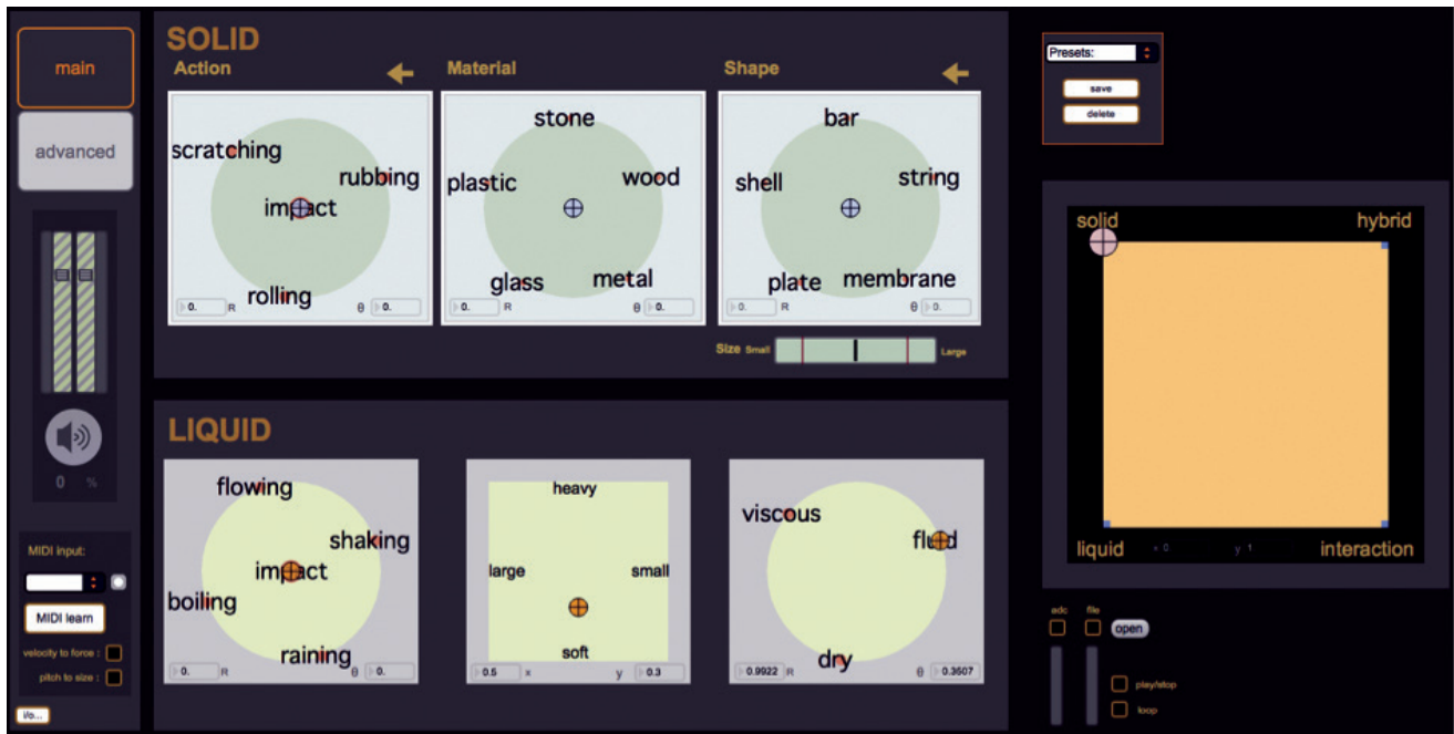
Espace de navigation sonore issue du paradigme (action/objet). La partie supérieure permet la construction de sons « solidiens » à partir de l'ajustement continu de la matière, la forme et la taille de l'objet virtuel, puis de l'action effectuée sur ce dernier. La partie inférieure permet la construction de sons liquides par ajustement du débit, de la pression, de la viscosité du liquide et du type d'écoulement. La partie de droite contrôle l'hybridation des invariants morphologiques. Elle permet ainsi des transitions continues entre des interactions naturelles (liquide tombant sur un solide) et imaginaires (écoulement d'objets métalliques).
